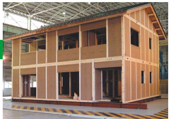
(独)防災科学技術研究所(つくば市)にて連続5回 巨大地震波 加振後の実物大住宅モデル
